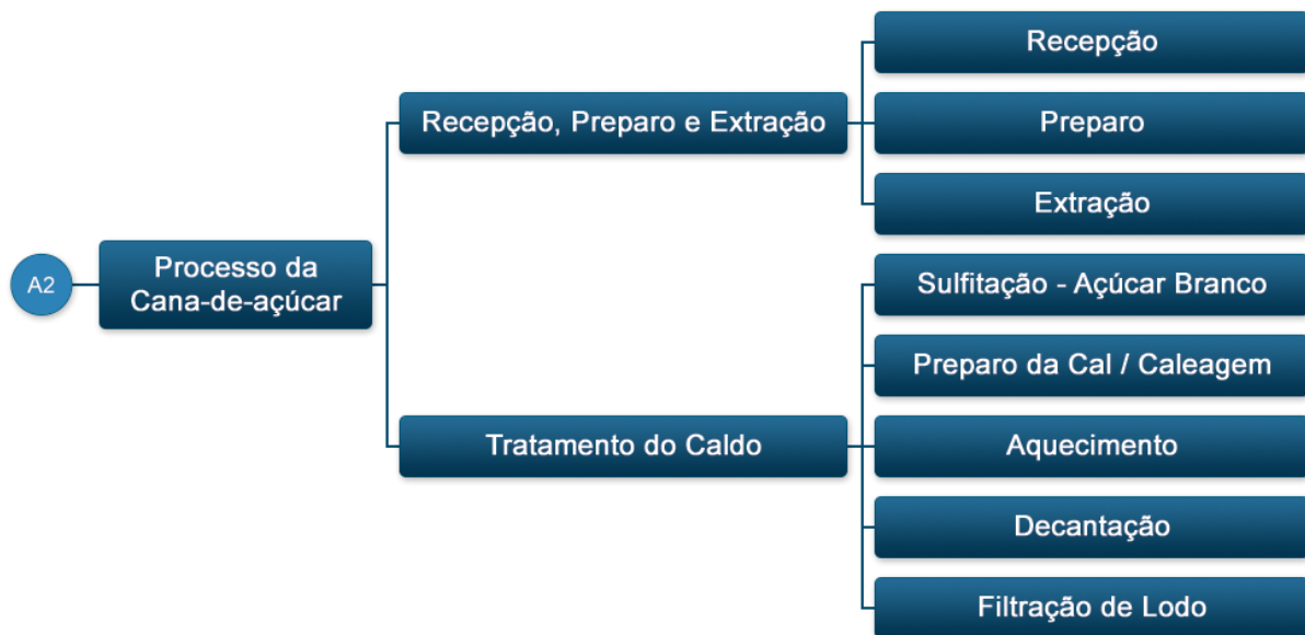
Figura 21: Estrutura do Processo da Cana-de-açúcar.
