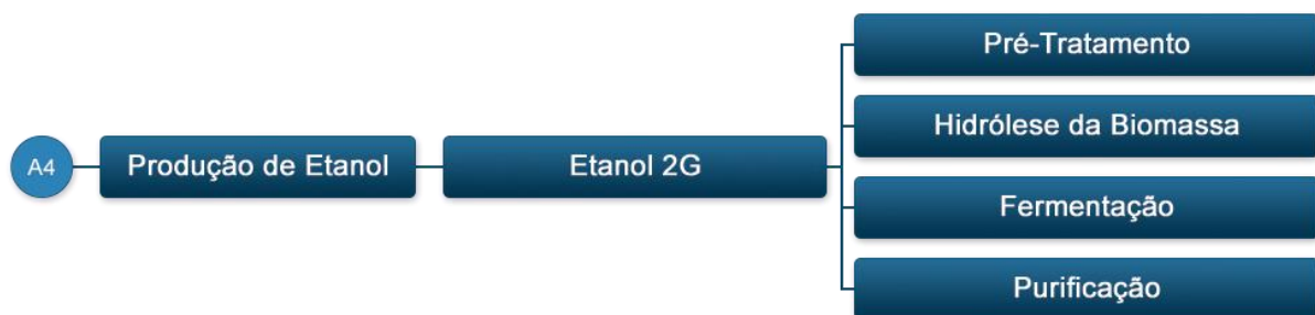
Figura 35: Estrutura da Produção de Etanol – Etanol 2G.
