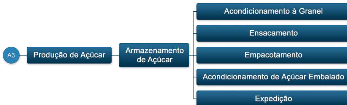
Figura 29: Estrutura da Produção de Açúcar - Armazenamento de Açúcar.
