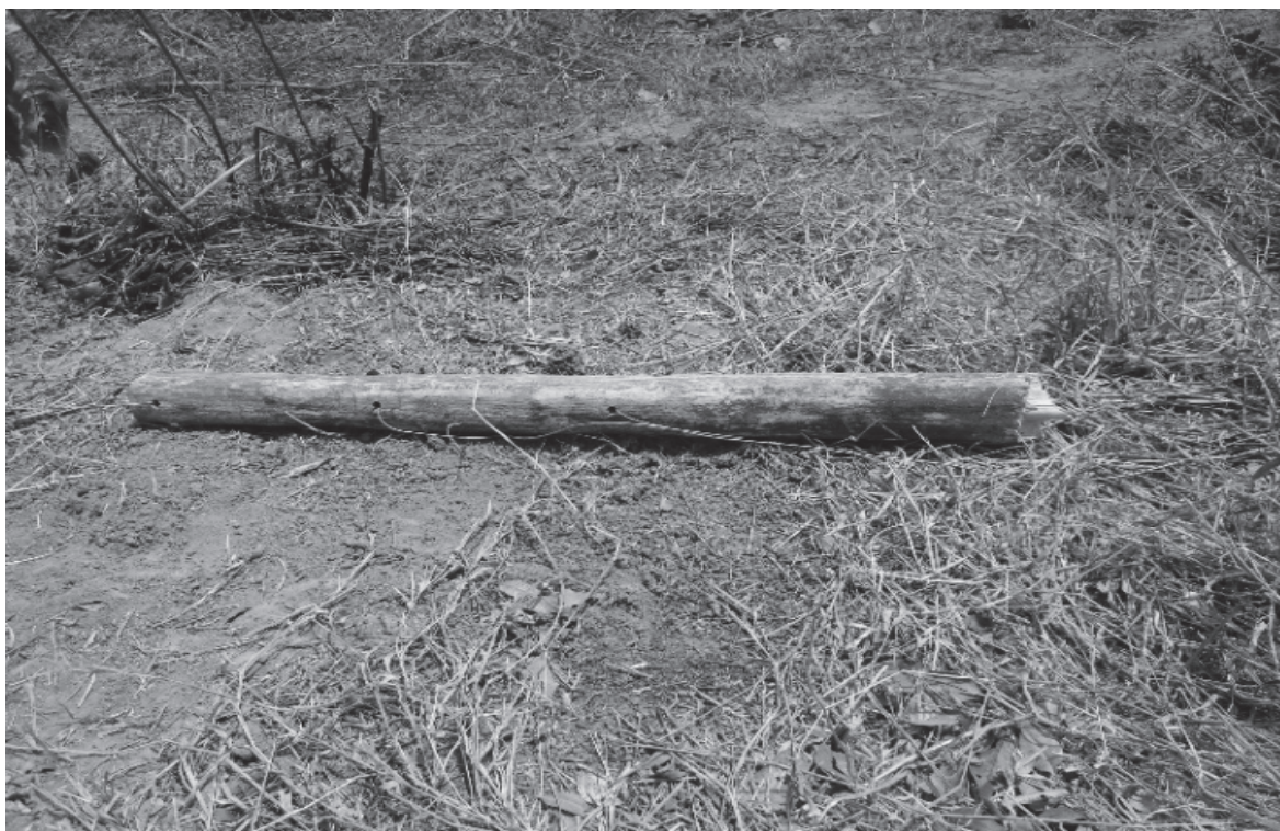
Figura 4 - Foto da Lasca de Teca Apodrecida após um Ano de Uso na Propriedade do Agricultor C1, Alta Floresta, Estado de Mato Grosso.
